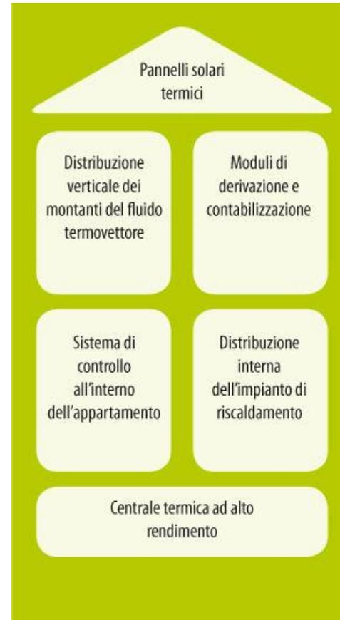
L'impianto è centralizzato con contabilizzatori di calore, è costituito da 3 caldaie a condensazione e un impianto solare che copre il 70% del fabbisogno dell'acqua calda sanitaria. Il sistema di erogazione è a pannelli radianti. Ciò ha permesso di raggiungere un consumo di **21.23 kWh/mq annuo**
